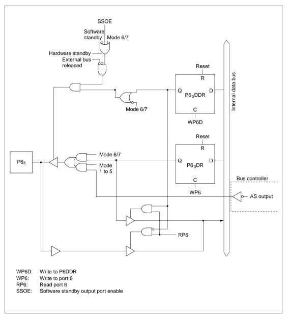
Figure C.6 (d) Port 6 Block Diagram (Pin P63)
