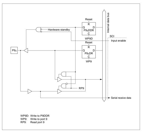
Figure C.9 (d) Port 9 Block Diagram (Pin P9<sub>3</sub>)
