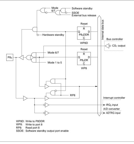
Figure C.8 (d) Port 8 Block Diagram (Pin P83)
